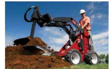
**HIGH TORQUE AUGER POWER HEAD**
